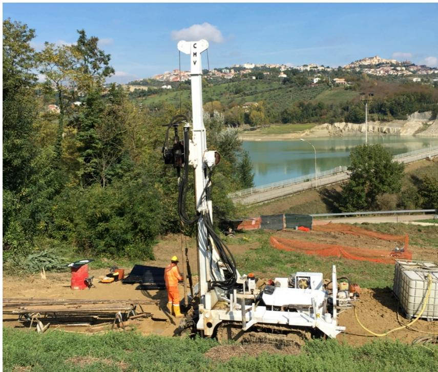
I sondaggi geognostici sono stati realizzati a carotaggio continuo con utilizzo di carotiere semplice avente diametro pari a 101mm e corona in widia. Per l'attraversamento delle marne ed argille marnose di base, trattandosi di terreno ad elevata consistenza passante a roccia tenera, è stato
